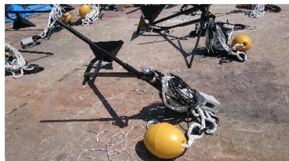
現地港湾にて主な底質場所（砂および泥）を数点選択し把駐テストを行いました。V型片爪金錨 VRS-75 は把駐力 9.8~13.7KN を確認し、他社（旧式）の錨では場所によって 9.8KN 以下で移動（走錨）する事が確認されました。港湾内の水面上昇を+3.5m まで考慮し、最も厳しい条件での安全性が確認され、これによりV型片爪金錨 VRS-75 の採用が決定しました。
